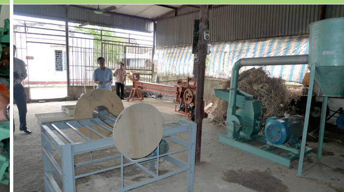
Máy chẻ nửa, máy chà nhám, máy nghiền tại Công ty L&V
