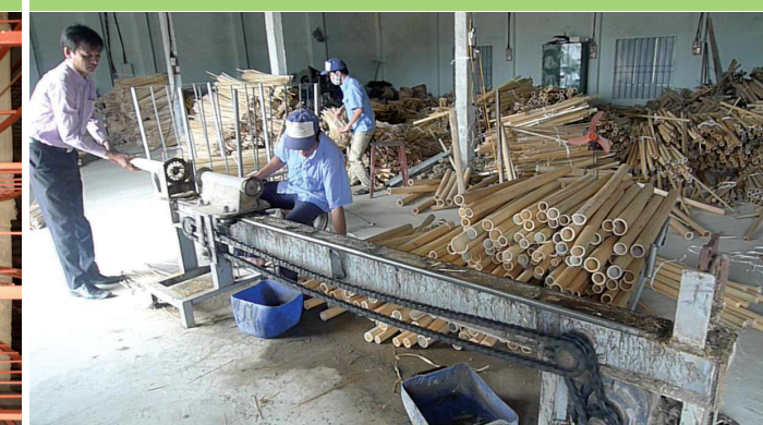
Máy chẻ nửa, máy chà nhám, máy nghiền tại Công ty L&V
