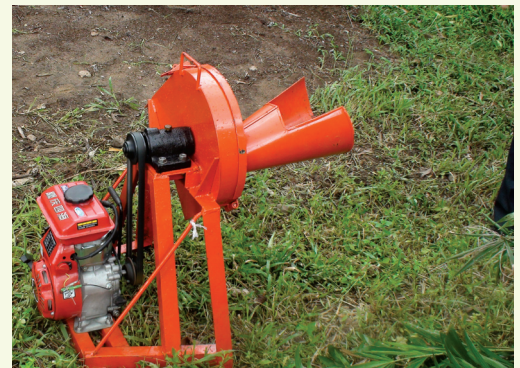
Máy cắt lá mây chạy bằng xăng
