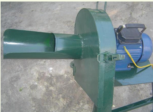
Máy cắt lá mây chạy bằng điện
