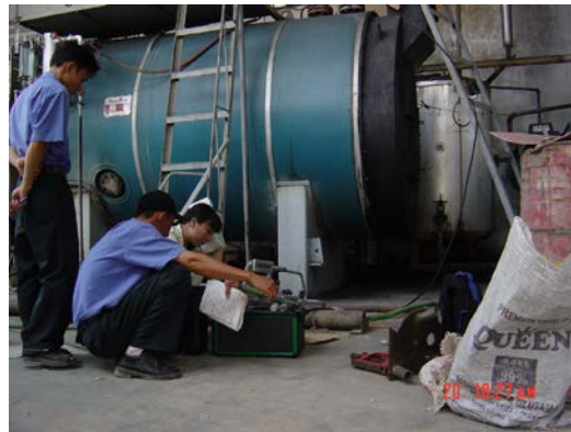
Đo đạc bằng máy phân tích khói lò có thể minh chứng tiềm năng của SXSH ngay tại hiện trường
